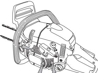
**ВАЖНО!** Для осуществления метода центробежной очистки нужно постоянно выполнять техническое обслуживание и уход за системой. Необходимо чистить воздухозаборник стартера, лопасти вентилятора на маховике, пространство вокруг маховика, входного коллектора и карбюратора.
