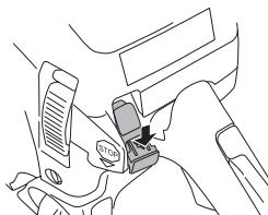
Обратите внимание! Выключатель Запуск/Остановка автоматически переходит рабочее положение. В целях избежания непроизвольного запуска, головка свечи должна быть всегда снята со свечи при сборке, проверке и/или обслуживании.
