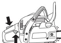
После этого оставьте машину работать на холостом ходу на несколько секунд, а затем дайте полный газ.
