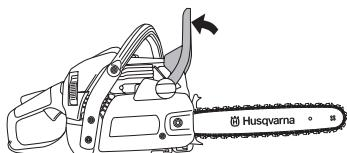
Открутите гайку крепления шины пилы и снимите крышку сцепления (тормоз цепи). Снимите транспортировочное кольцо (A).
