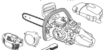
Производите очистку системы охлаждения щеткой раз в неделю или чаще, если этого требуют условия работы. Загрязненная или засоренная система охлаждения может привести к перегреву машины и вызвать повреждение поршня и цилиндра.
