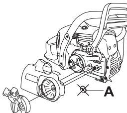
Установите пильное полотно на специально предназначенные болты. Установите полотно в самое заднее положение. Оденьте цепь на ведущую звездочку и вставьте ее хвостовики в паз пильного полотна. Начинайте с верхней стороны пильного полотна.
