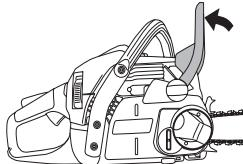
Открутите натяжной шкив цепи и снимите крышку сцепления (цепной тормоз). Снимите защиту при транспортировке. (A)
