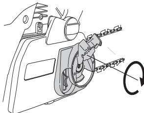
При установке новой цепи следует часто проверять ее натяжение, пока цепь не приработается. Регулярно проверяйте натяжение цепи. Регулярно проверяйте натяжение цепи. Правильно натянутая цепь обеспечивает высокое качество пиления и дольше служит.
