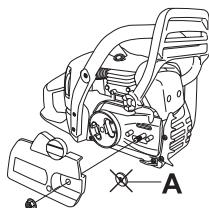
Смонтируйте шину пилы на специально предназначенном болте. Установите шину пилы в самое заднее положение. Оденьте цепь на ведущую шестерню и вставьте ее хвостовики в паз шины пилы. Эту операцию следует начать с верхней стороны шины пилы.
