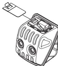
При установке сетки убедитесь, что она установлена в верном положении. При необходимости используйте для установки или удаления сетки комбинированный гаечный ключ.
