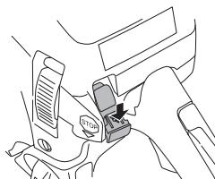
Остановка двигателя осуществляется нажатием на выключатель запуска/остановки. Обратите внимание! Выключатель Запуск/Остановка автоматически переходит рабочее положение. В целях избежания непроизвольного запуска, головка свечи должна быть всегда снята со свечи когда вы оставляете машину без присмотра.
