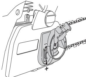
Цепь натянута правильно, если она не провисает под направляющей, но ее можно свободно провернуть вручную. Придерживая носовую часть направляющей, затяните ее сцепление, поворачивая ручку по часовой стрелке.
