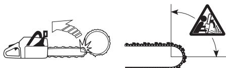
Отдача всегда происходит в плоскости резания пилы. Обычно при отдаче моторную пилу отбрасывает назад и вверх в направлении
